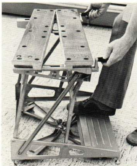
2. Les manivelles indépendantes de l'étau donnent l'angle d'ouverture voulue.
