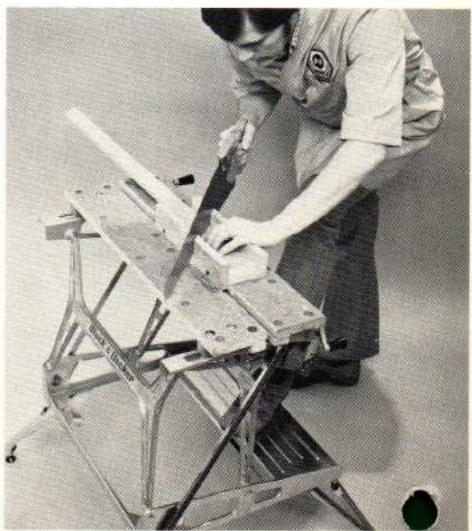
6. Le serrage d'une boîte à onglet pour des coupes d'onglets plus précises. Remarque: Placer le poids de votre corps sur la base du Workmate pour plus de stabilité lorsque vous sciez ou exécutez d'autres travaux.
